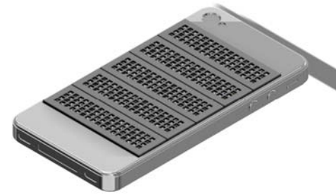
Versorgung eines Smartphones mit Hilfe einer Mikrobrennstoffzelle (Skizze)
